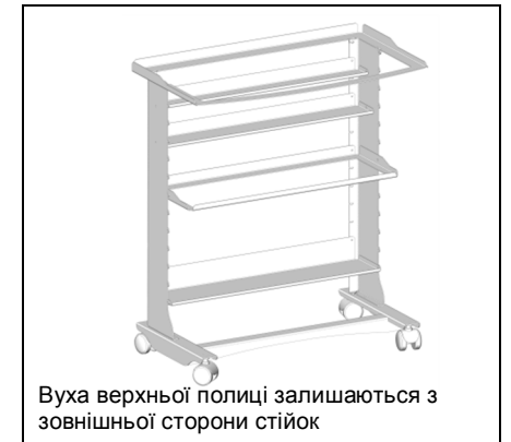
Мал.6 Кріпимо полицю гвинтом М4х10
